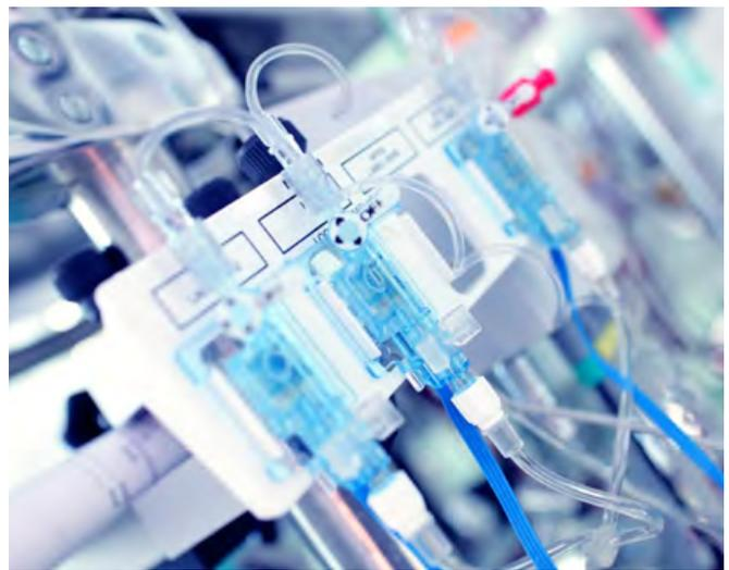
正电阻，可对传感器进行补偿和校准。陶瓷基板上附有一个塑料盖，可以确保轻松连接到血压计配件并保护感应元件。传感器感应元件被包裹在电介质绝缘胶内以确保电路和液体隔离。1620 压力传感器采用批量生产，每个陶瓷基板上均采用 10x12 元件阵列（即每个基板上共有 120 件）。该产品使用卷带加静电袋包装进行交付。可根据特殊订单定制性能特性和封装，以满足临床应用的特殊要求。
